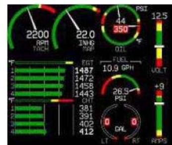
des barres. Sur un affichage EGT/CHT divisé (moteurs à deux et quatre cylindres seulement), les CHT sont affichées avec leur propre ensemble de barres vertes sur une autre échelle que celles des EGT, avec leurs valeurs numériques affichées à droite de chaque barre. Sur un affichage 1/3, à l'exception d'un moteur à deux cylindres, l'affichage EGT/CHT est en mode combiné.
